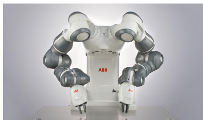
(a) Robot Yumi à deux bras de ABB
