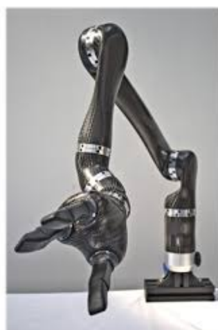
(e) Robot Jaco pour la recherche et les personnes tétraplégiques
